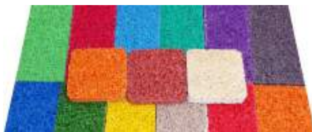
Илл. 1.1.11. ЦВЕТНЫЕ EPDM-ГРАНУЛЫ ДЛЯ ИЗГОТОВЛЕНИЯ РЕЗИНОВОГО ПОКРЫТИЯ
