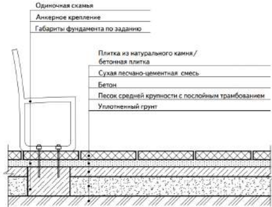
Илл. 5.1.1. ПРИНЦИПИАЛЬНАЯ СХЕМА МОНТАЖА СКАМЬИ В МОЩЕНИЕ
